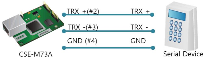
图 8-3 正确的RS485 连接
