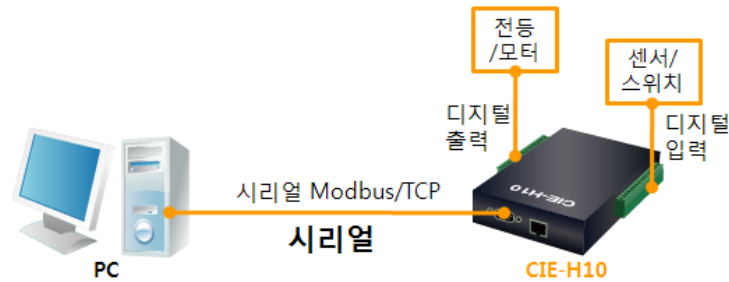
그림 1-2 시리얼 Modbus/TCP 구성 예
